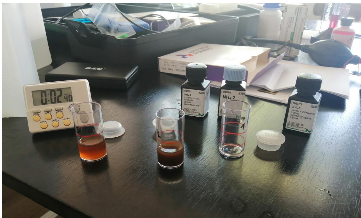
Obr. 7: Meranie rôznych foriem dusíka, foto: Michal Sedlák
