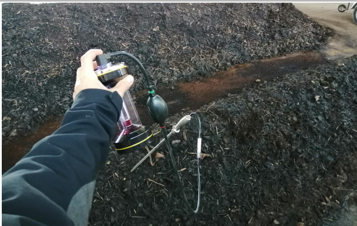
Obr. 3: Meranie obsahu CO 2 v kompostovej zakládke, 7.10.2022, foto: Michal Sedlák
