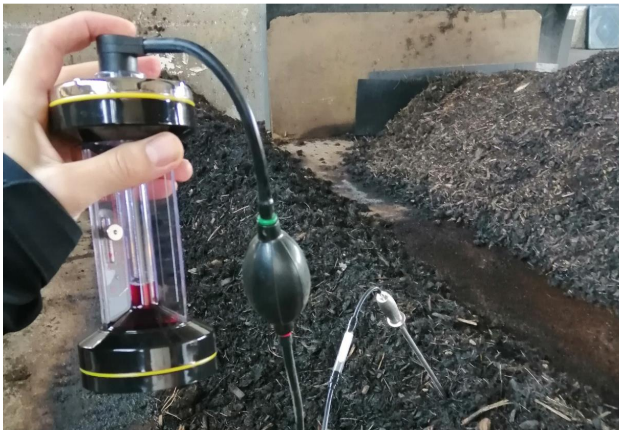
Obr.4 : Meranie obsahu CO 2 v kompostovej zakládke, 7.10.2022, foto: Michal Sedlák
